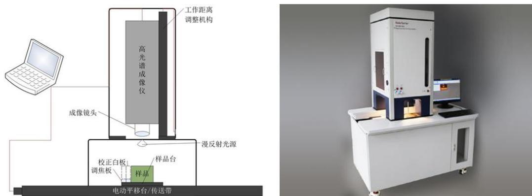
图 1 GaiaSorter 高光谱分选仪结构图与实景图
